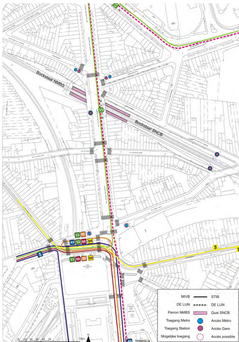
Illustration 7 : Bockstael – les lignes de transport public et les accès au train et au métro.
